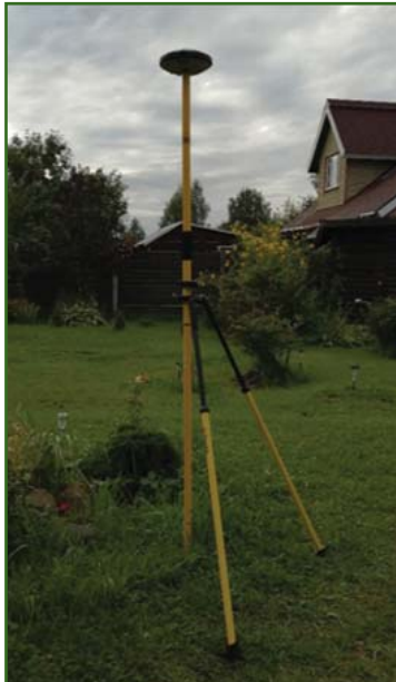
Рис. 2 Общий вид ГНСС-приемника на вешке с биподом
